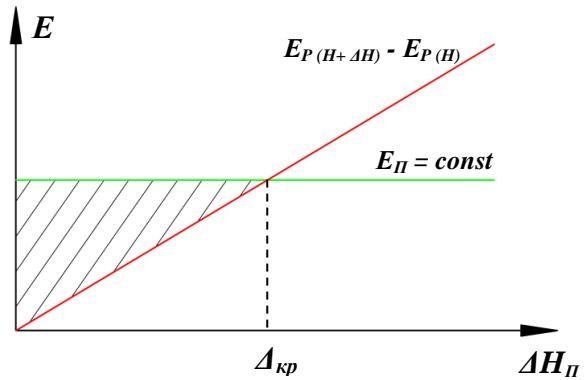
На графике зеленым цветом обозначена кривая энергии, вырабатываемая устройством при любом значении суммарного перемещения поршня (исходя из условия постоянства прокачиваемого объема). Красным цветом – потери при трансформации потенциальной энергии системы в целом в кинетическую, обусловленные перемещением поршня. Получение избыточной энергии возможно только в случае, если  $\Delta H_{\text{п}} < \Delta_{\text{kp}}$ .
