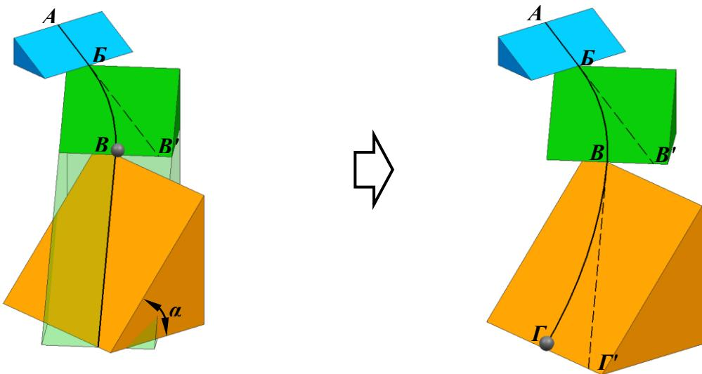
В итоге мы получили криволинейную траекторию движения шара. Ниже на изображении показано сравнение прямолинейной и криволинейной траектории при скатывании шара с одной и той же высоты:
