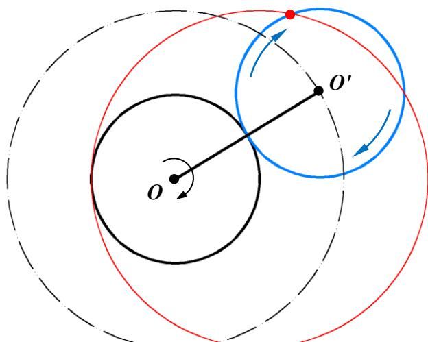
Неподвижная (обкатываемая) окружность с центром в точке  $O$  соединяется направляющей с подвижной (обкатывающей) окружностью с центром в точке  $O'$ . Вращение направляющей задает движение центру подвижной окружности, которая начинает обкатывать неподвижную окружность. Траектория движения одной из точек подвижной окружности изображена красным цветом.
