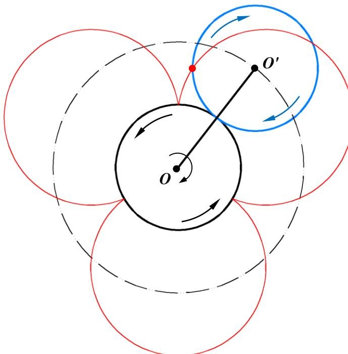
Можно дополнительно задать вращение обкатываемой окружности в сторону, противоположную вращению направляющей. В зависимости от скорости данного вращения можно управлять траекторией движения точек обкатывающей окружности. На данном изображении красным цветом показана одна из возможных траекторий движения точки обкатывающей окружности.
