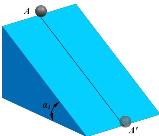
На изображении сплошной линией показана траектория пятна контакта шара и плоскости при скатывания шара из точки  $A$  в точку  $A'$  по плоскости с углом наклона  $\alpha_1$ .
