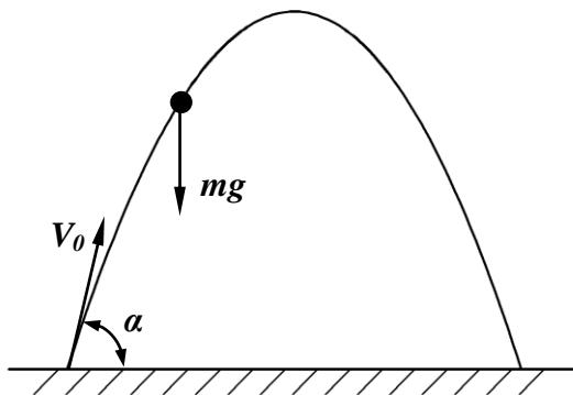
Здесь  $V_0$  – начальная скорость вылета снаряда,  $\alpha$  – угол, под которым направлен начальный вектор скорости снаряда.
