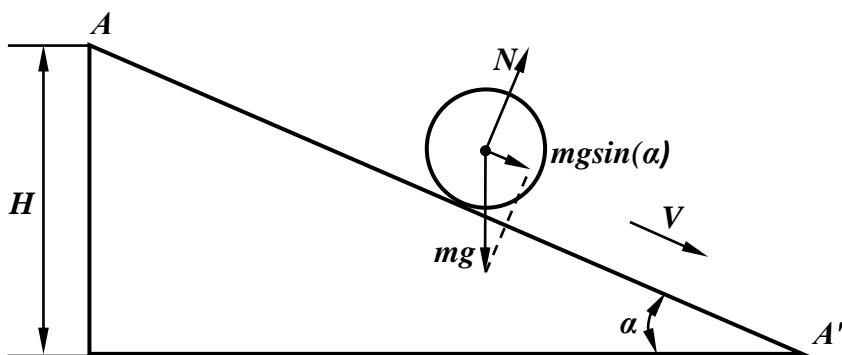
Движение шара вызывает проекция силы тяжести на плоскость качения. В соответствии с законом сохранения энергии, уравнение, выражающее переход потенциальной энергии покоя шара в кинетическую энергию движения, выглядит следующим образом:
