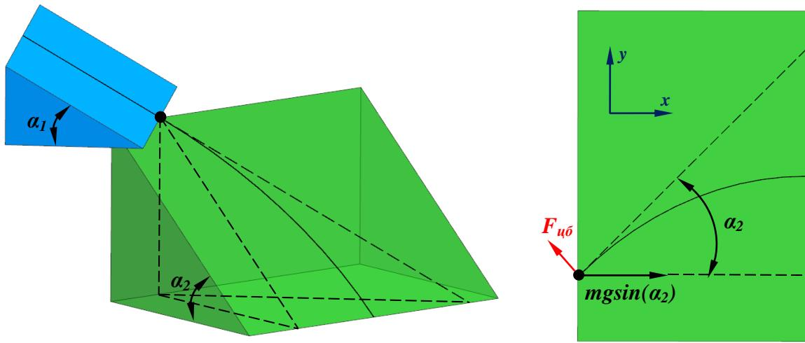
В момент перехода точечной массы с одной плоскости на другую и начале движения по криволинейной траектории, возникает центробежная сила инерции, направленная по нормали к касательной к криволинейной траектории, причем рассматриваемая точка перехода будет являться вершиной параболы. При этом возникающая центробежная сила инерции не будет компенсироваться реакцией опоры. Это означает, что в данный момент для проекций ускорения, действующего на точечную массу, будут справедливы следующие уравнения:
