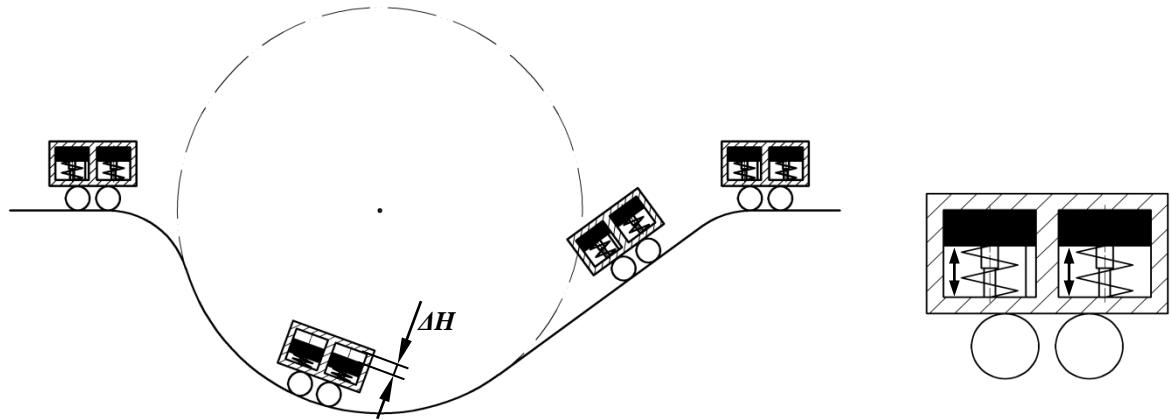
В обоих случаях предполагается для получения работы использовать перемещение груза под действием центробежной силы инерции и возврат его в исходное положение под действием пружины на участке отсутствия данной силы. Способы представляют собой либо качание маятника, либо преодоление тележкой потенциальной ямы. Груз, перемещаясь на величину  $\Delta H$ , совершает работу, но в то же время эта величина определяет потери при переходе потенциальной энергии в кинетическую.
