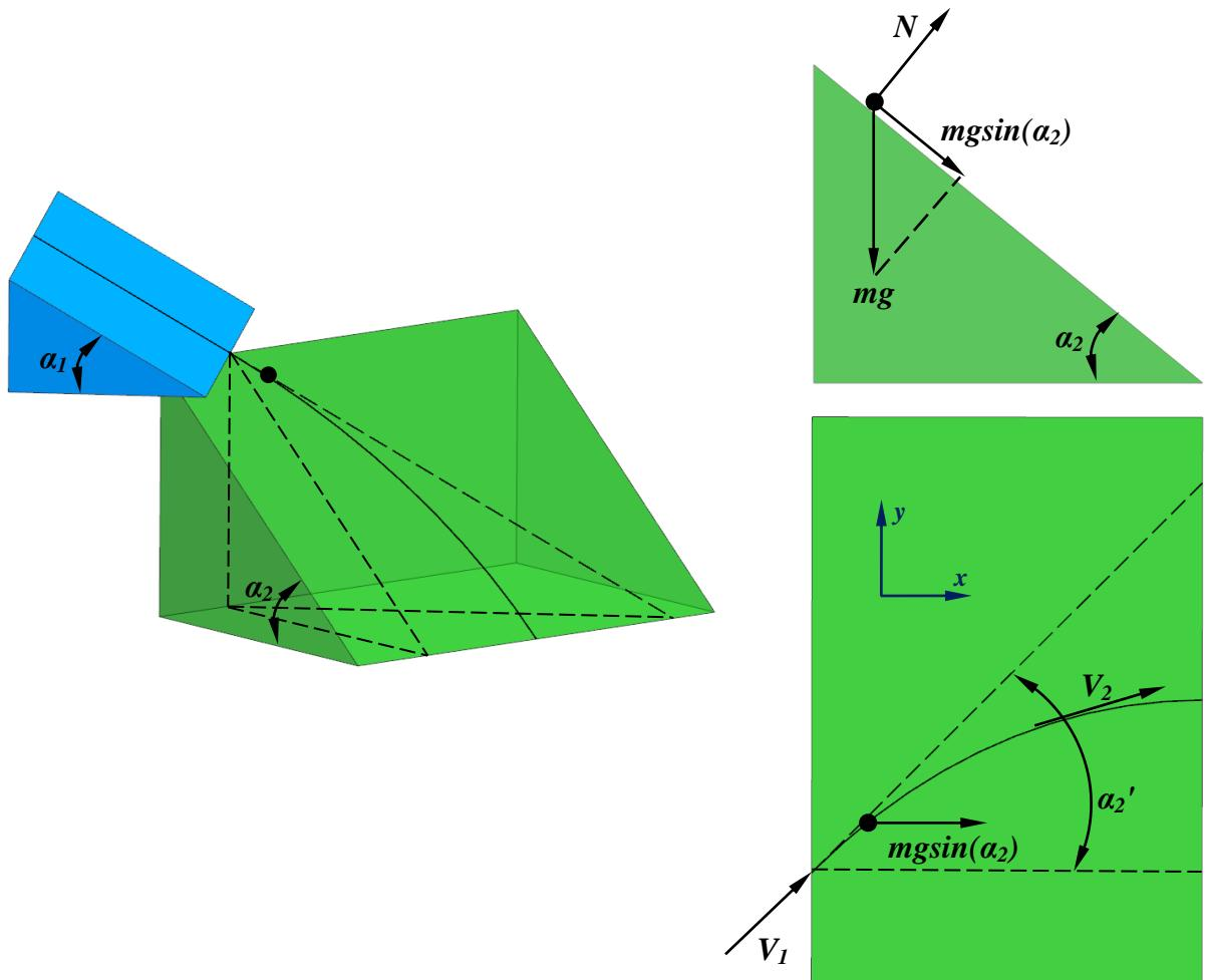
Расположим систему координат в новой плоскости скольжения, ось  $x$  направим вдоль проекции силы тяжести на плоскость. Уравнения движения точечной массы будут выглядеть следующим образом:
