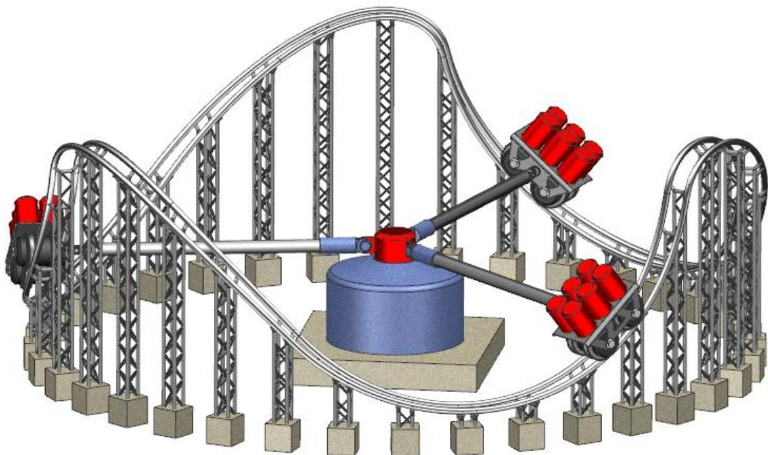
Попробуем провести расчет энергетического баланса для данных конструкций. Рассмотрим соотношение между потерями от перемещения поршня и полезной работой, совершающейся поршнем за счет центробежной силы инерции при качании маятника с жестким подвесом.
